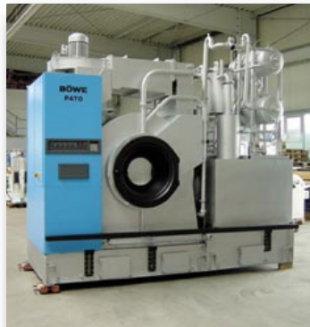
Komplett überholte und auf dem Prüfstand getestete Textilreinigungsmaschine fertig zur Auslieferung
