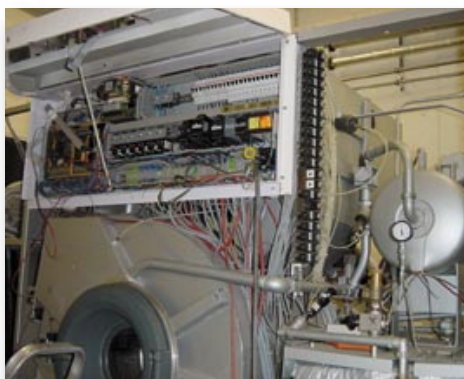
Abnahme einer Textilreinigungsmaschine auf einem unserer Prüfstände
